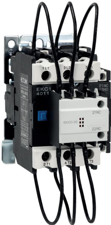
Contactador trifásico para banco de condensadores 25Kvar, con bobina 220V. 50/60Hz. más 1 contacto auxiliar NA y 2 NC
